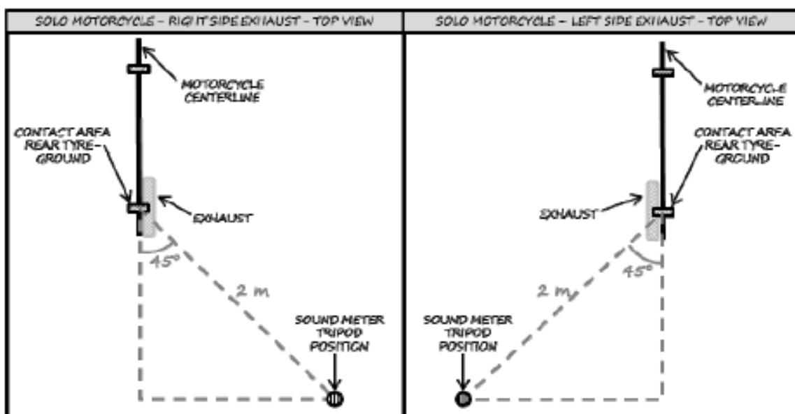
Η στάθμη θορύβου μετρούμενη σε απόσταση δύο (2) μέτρων από το άκρο της εξάτμισης υπό γωνία  $45^{\circ}$  υπό τον εγκάρσιο άξονα της μοτοσυκλέτας, δεν πρέπει να ξεπερνά **τα 111 dB** με τις στροφές του κινητήρα στο μέγιστο όριο, το οποίο πρέπει να κρατηθεί για ένα τουλάχιστον δευτερόλεπτο.
